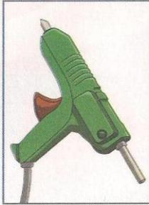
El pegamento termo-fusible es muy empleado en el taller de tecnología. Se trata de un material adhesivo que se aplica calentándolo con una herramienta llamada pistola.
