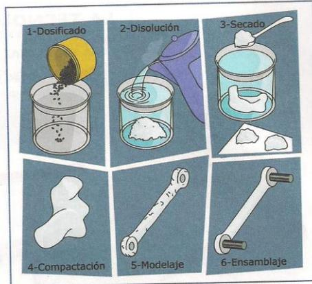
Para comprender el proceso de producción industrial de plástico pondremos como ejemplo un procedimiento de fabricación casero, que puede ser muy útil en labores de bricolaje y reparación de pequeñas piezas.
